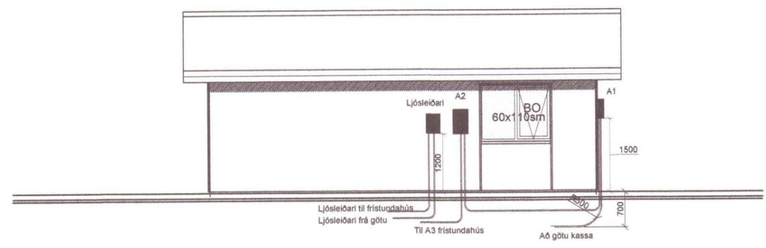
Milli greina töflu og mælakassa skal leggja 50mm PEH rör. Frá aðaltöflu skal leggja 50mm PEH rör að greinatöflu í geymslu.
