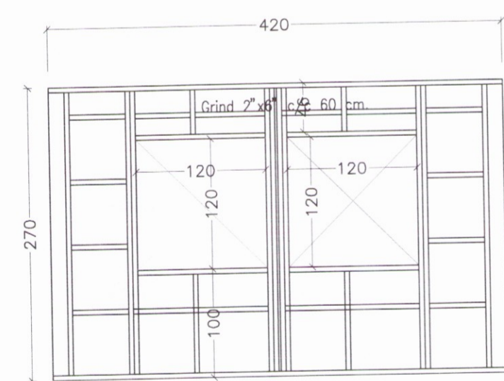
V10 5/7 ÚTVEGGJAGRIND V10 1:50
