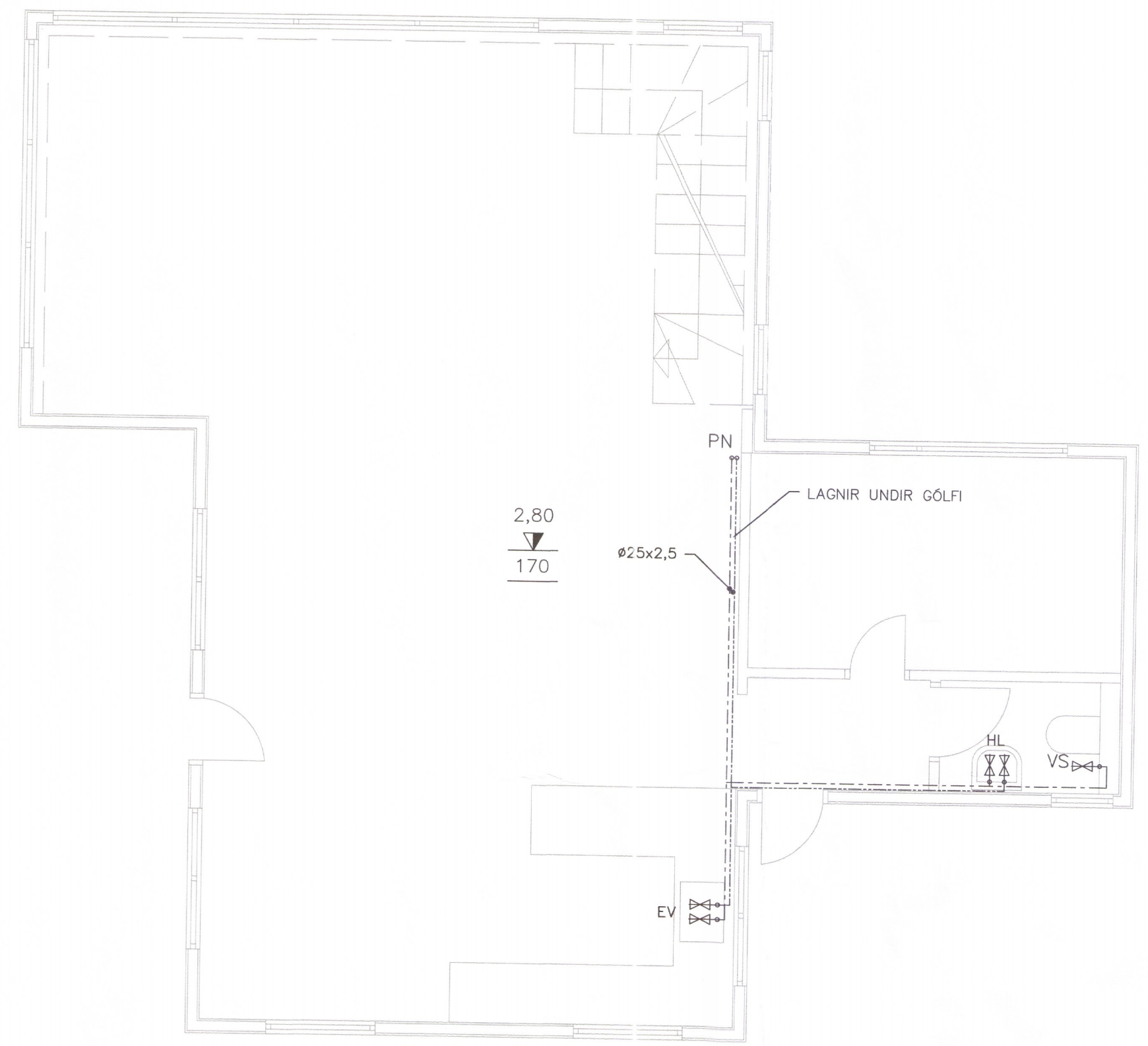
1 GRUNNMÝND 1.HÆÐ - NEYSLUVATN MKV. 3
