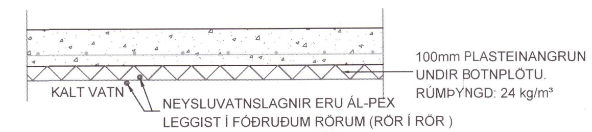
Snið frágangur neysluvatnslagna undir botnplötu
