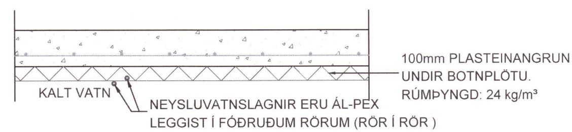
Snið frágangur neysluvatnslagna undir botnplötu 1:20
