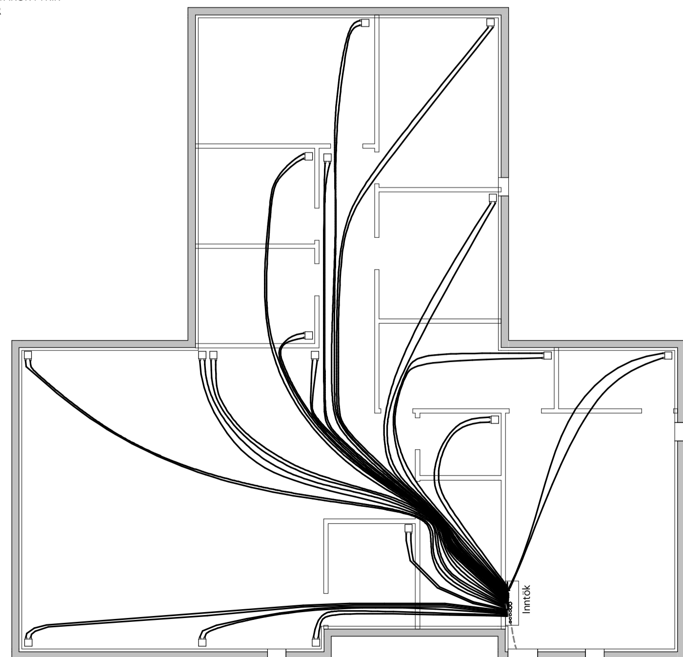
3 Lagningar Hitalagnir Tengistaða 1:100
