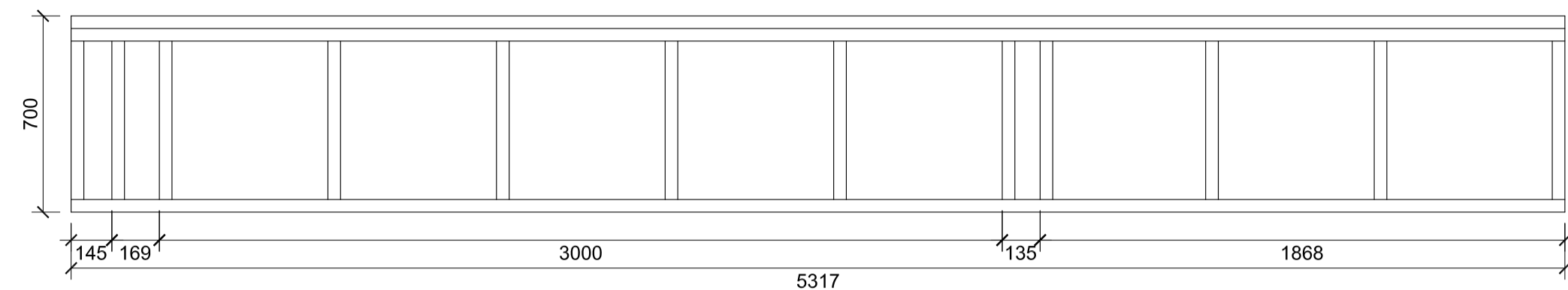
V17 Veggjagrind 1:20 Ásýnd utan frá Magn 1 stk. Efní Burðarvölr T1 45x145
