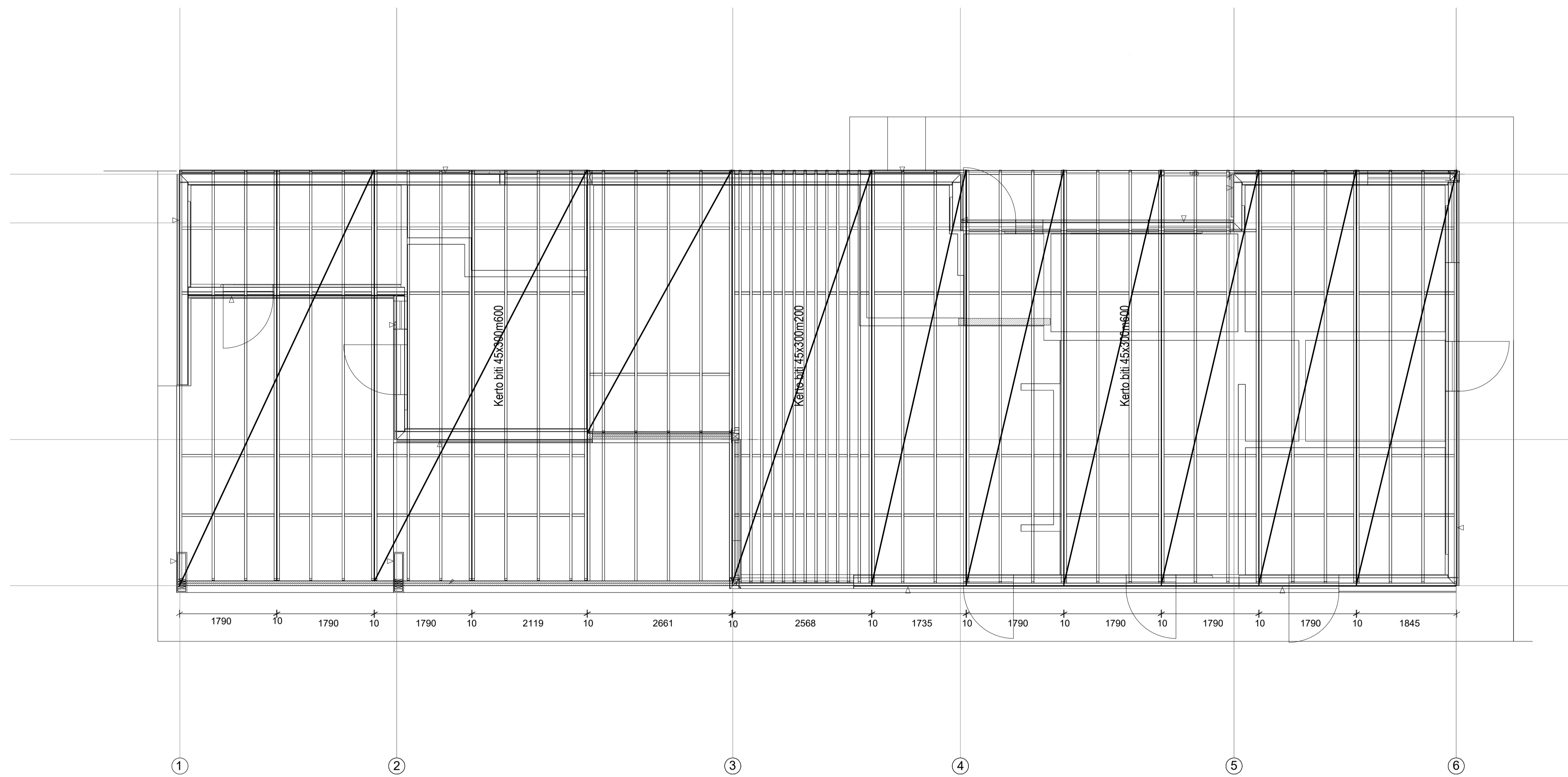
Grunnmynd þakeningar Mkv = 1:50
